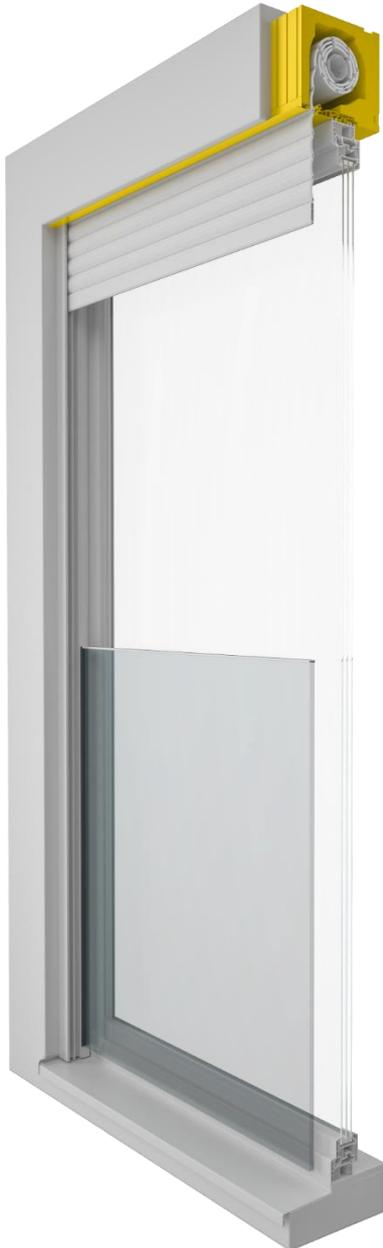
**Bild 2:** Speziell für bodentiefe Fenster ist der AK-Flex.2 mit einer bereits komplett integrierten Glasabsturzsicherung erhältlich. Das Glas wird direkt in die Führungsschiene zwischen Fenster und Rollläden bzw. Raffstore eingesetzt und verdeckt befestigt.
